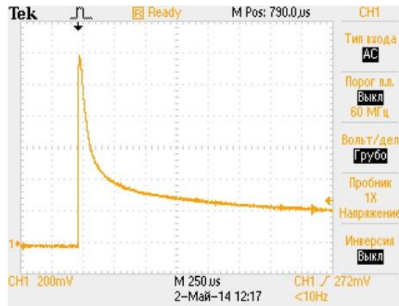
Рис.3. Осциллограмма фототока в нелегированных образцах GaSe (цена одного деления по оси абсцисс равна 250 микросекунд).
